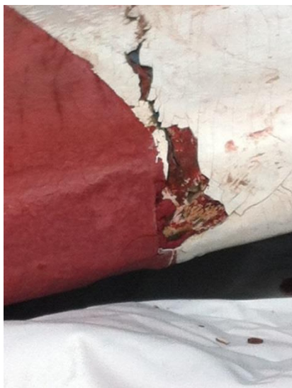
Schade na gebroken roer 'Freya'
