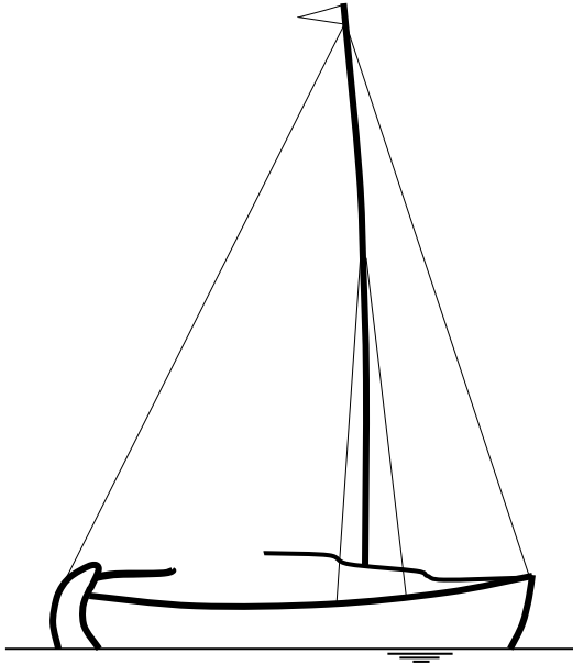
Fig. 3 De mast wordt in een flauwe bocht gesteld
